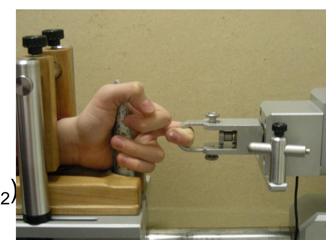
Abb.3: Messung der Fingerbeugekraft am Mittelglied des Mittelfingers III4
